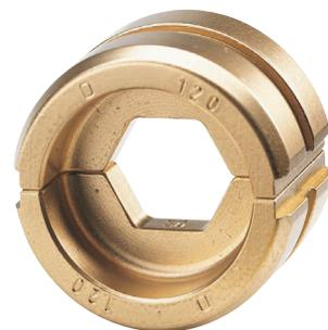
pour cosses et raccords en aluminium DIN 46329 et sertissage hexagonal similaire, largeur de pressage 7 mm
